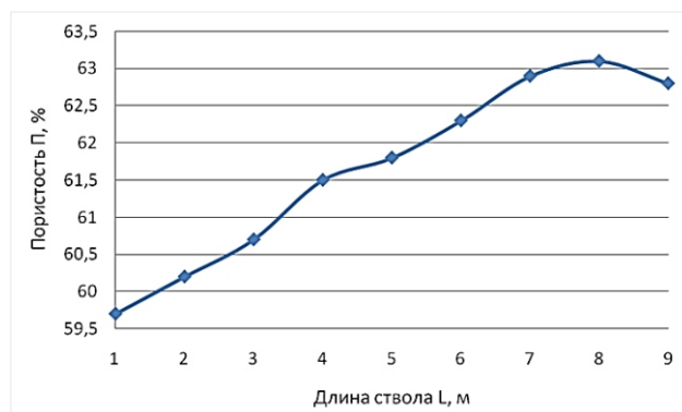
Рис. 4. Среднее значение пористости древесины березы по длине ствола
