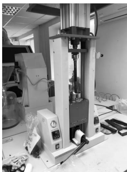
Рис. 3. Инжекционная литьевая машина для пробоподготовки
