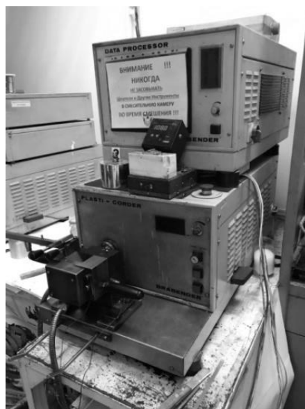
Рис. 1. Общий вид смесителя Brabender «PLAsti-Corder® Lab-Station»
